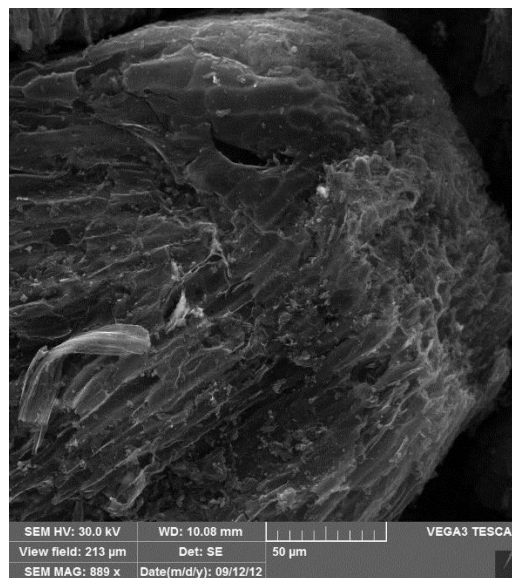
Рисунок 13. Микрофотография материала ME46902K111N с масштабной линейкой 50 мкм (удельная поверхность 970 м 2 /г)
