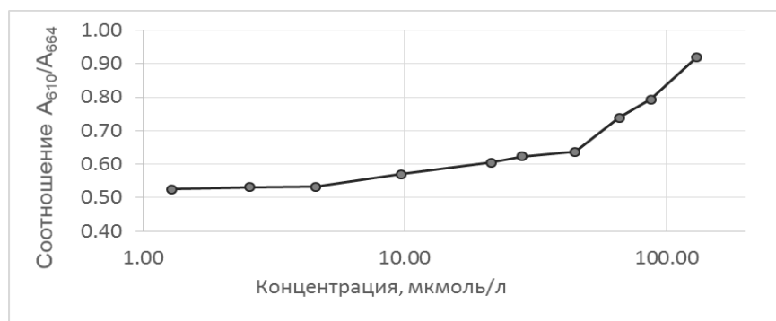
Рисунок 9. Зависимость соотношения пиков димера/мономера от концентрации красителя
